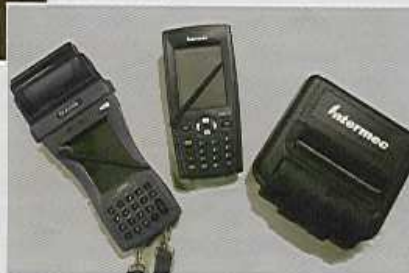
Bei den Münchener Handhelds sind die Drucker in das Gerät integriert (linkes Gerät), bei der Rosenheimer Variante (Mitte) ist der Drucker (rechts) als extra Gerät im LKW angebracht.
