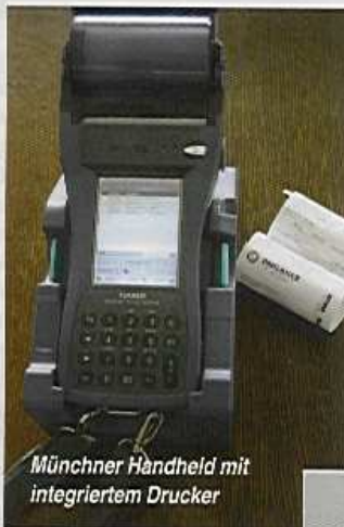
Bei den Münchener Handhelds sind die Drucker in das Gerät integriert (linkes Gerät), bei der Rosenheimer Variante (Mitte) ist der Drucker (rechts) als extra Gerät im LKW angebracht.
